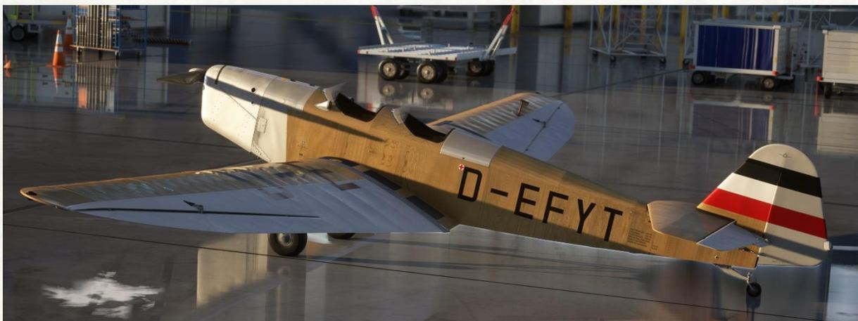
Ebenfalls 1934 gebaut, ist dies ein typisches Beispiel einer L25 im Werksanstrich: Alle Holzteile sind mit einem Klarlack versehen. Die Stoffbespannung und alle Metallteile sind in „silber-bronze“ lackiert, einer Art frühem Metallic-Lack.
